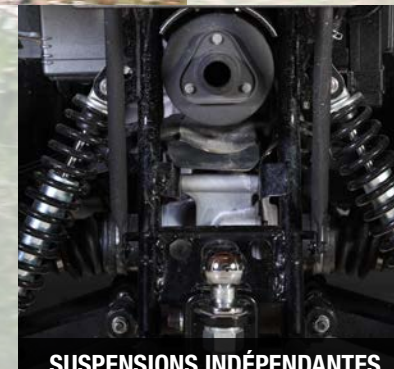
SUSPENSIONS INDÉPENDANTES AUX QUATRE ROUES (IRS)
