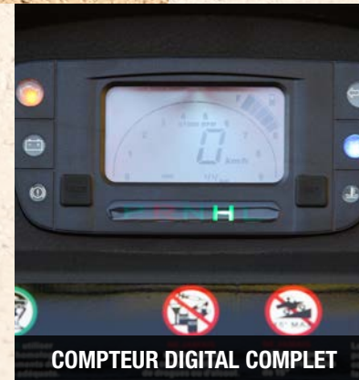
BOITE COURTE, LONGUE, NEUTRE, MARCHÉ ARRIÈRE ET FREIN DE PARKING
