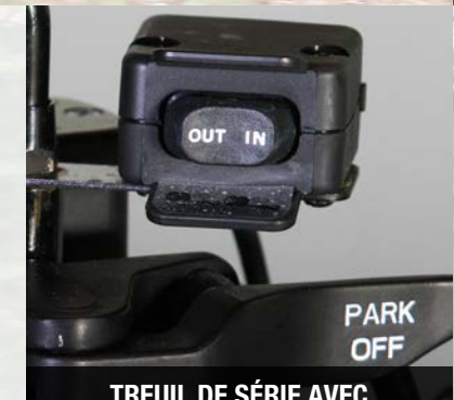
TREUIL DE SÉRIE AVEC COMMANDE AU GUIDON
